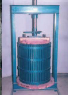
⇒ Utilizar prensas mais eficientes (por exemplo, prensas com parafuso) que o tipiti ou outro(s) tipo(s) de prensa(s) rústica(s) ainda encontrada(s).
