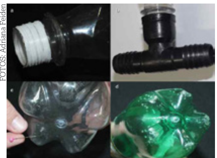
Figura 3 - Aplicação de fita veda rosca no bocal (a); garrafa rosqueada na emenda tipo "T" (b); perfuração do fundo o garrafa com o alfinete (c); garrafa com fundo perfurado (d).
