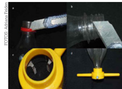
Figura 1 - Corte do anel de plástico (a); corte do ressalto da garrafa (b); vista superior da tarraxa no suporte (c) e posição do suporte para o início da rosca na garrafa PET (d).
